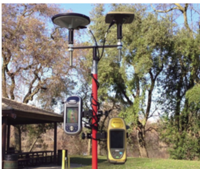
Rys. 5. ProMark 220 i konkurencyjny odbiornik – umieszczone na tej samej tyczce, razem z antenami zewnętrznymi
