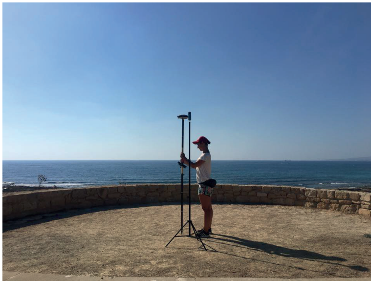
Wykorzystanie odbiornika Spectra Precision SP60 do inwentaryzacji zabytków Parku Archeologicznego Kato Pafos.
