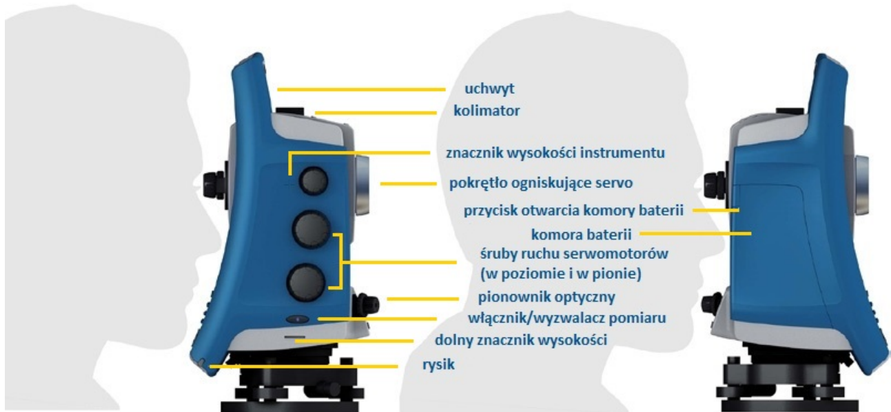
Rys. 1: Główne elementy tachimetru FOCUS 35
